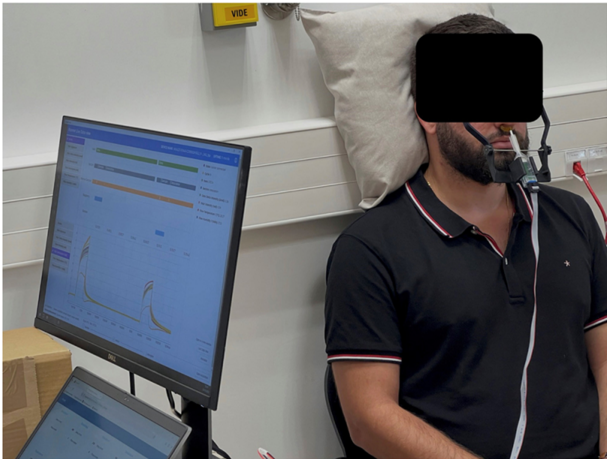
Légende : Le dispositif expérimental combinant le nez artificiel et le stimulateur.
