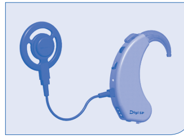
Figure a : Processeur vocal externe d'un implant cochléaire (marque Neurelec).
